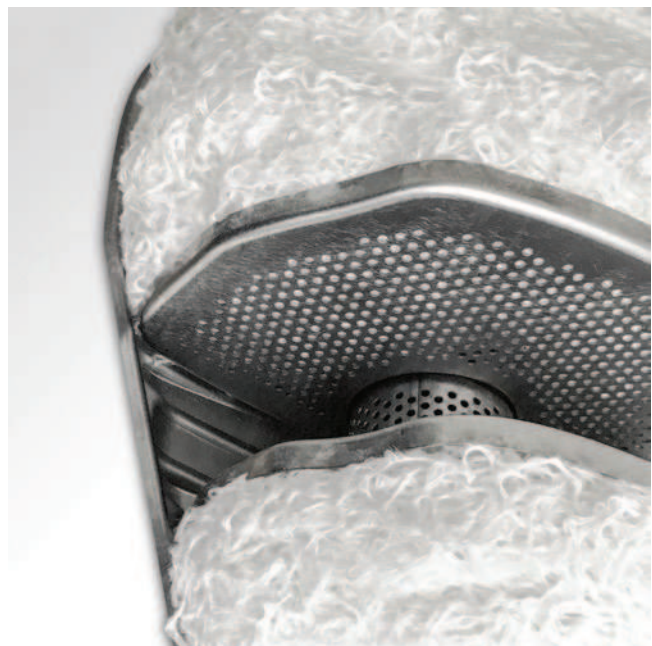
BILD 6 Der 3-D-Formkörper aus effekttexturierter ECR-Glasfaser kombiniert einen hohen Schallabsorptionsgrad, Montagefreundlichkeit, Passgenauigkeit sowie Umweltverträglichkeit mit einer konsequenten Positionstreue (© Isolite)
