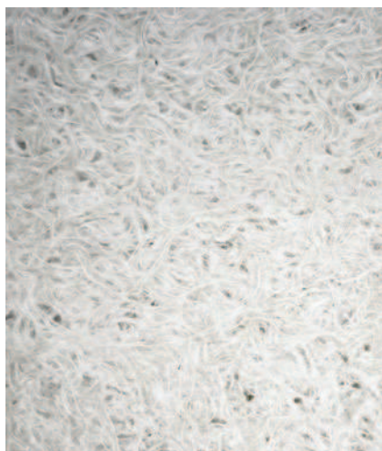
BILD 2 Die offenporige Oberfläche der 3-D-Formkörper sowie die effekttexturierte Struktur der Endlosfaser ermöglichen das hohe thermoakustische Potenzial (© Isolite)
